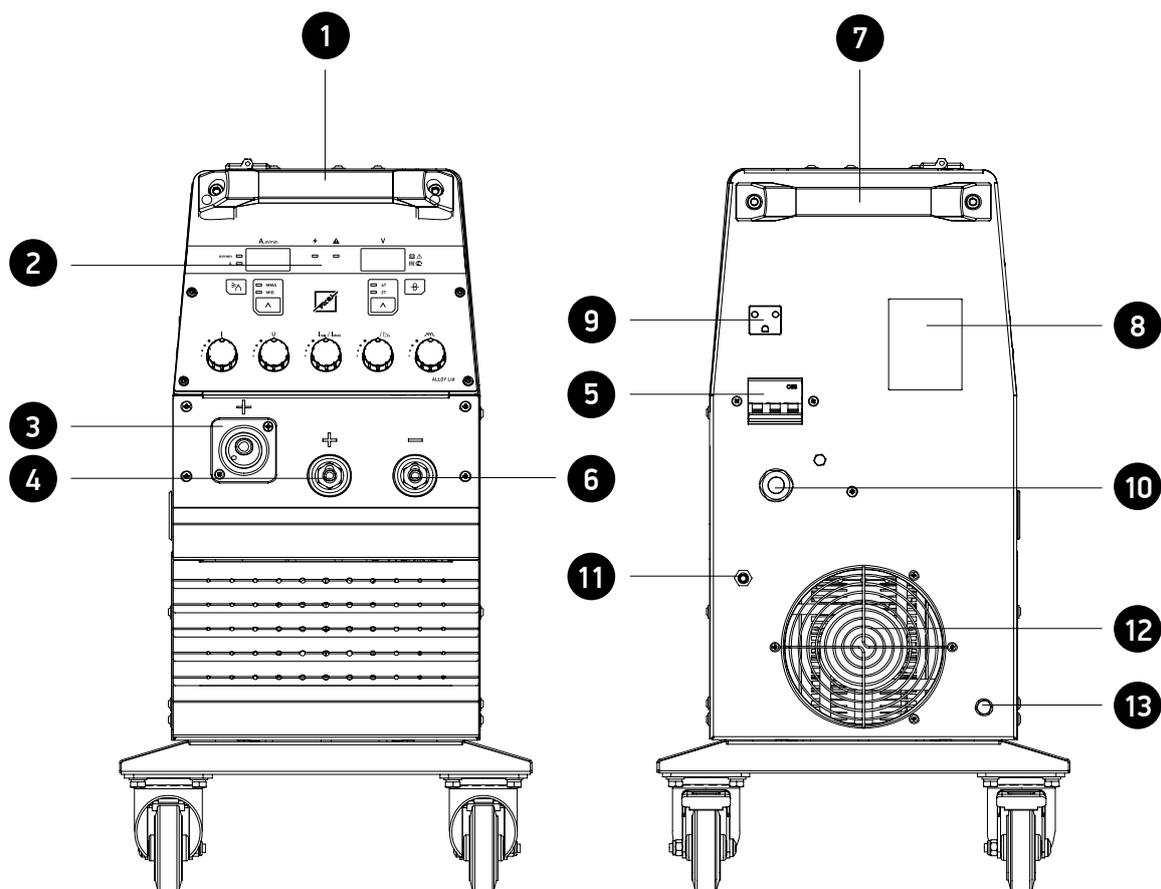
Рис. 2.2 Внешний вид аппарата MC-275 ME.
