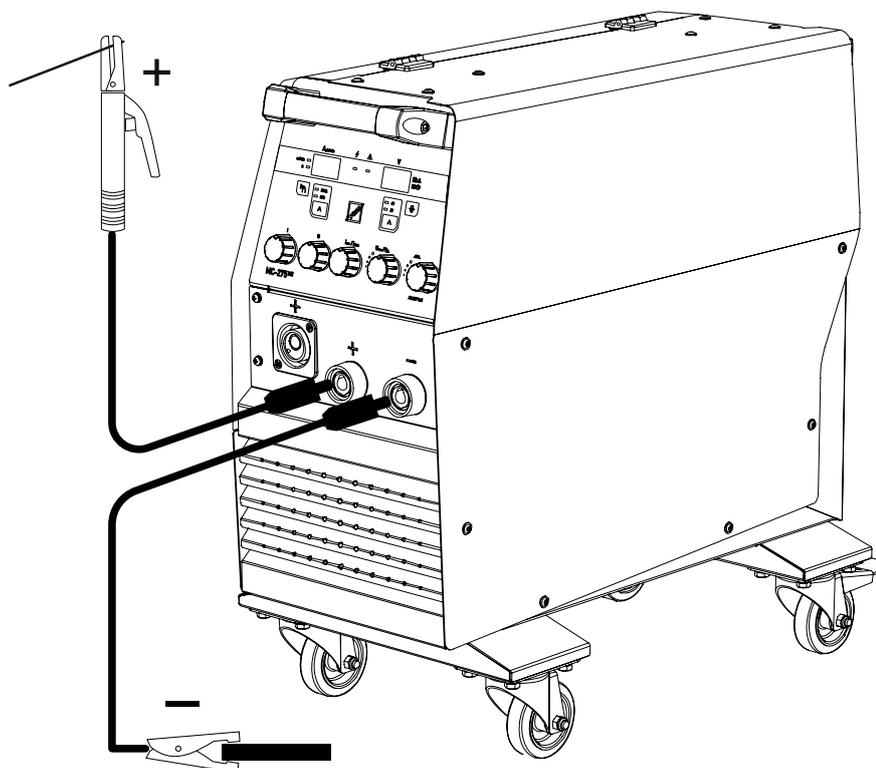
Рис. 5.6 Схема подключения аппарата в режиме MMA
