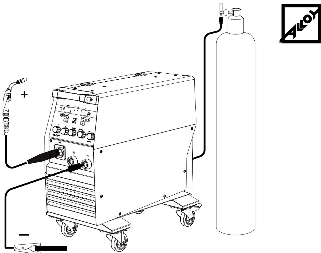
Рис. 5.4 Схема подключения аппарата в режиме MIG/MAG
